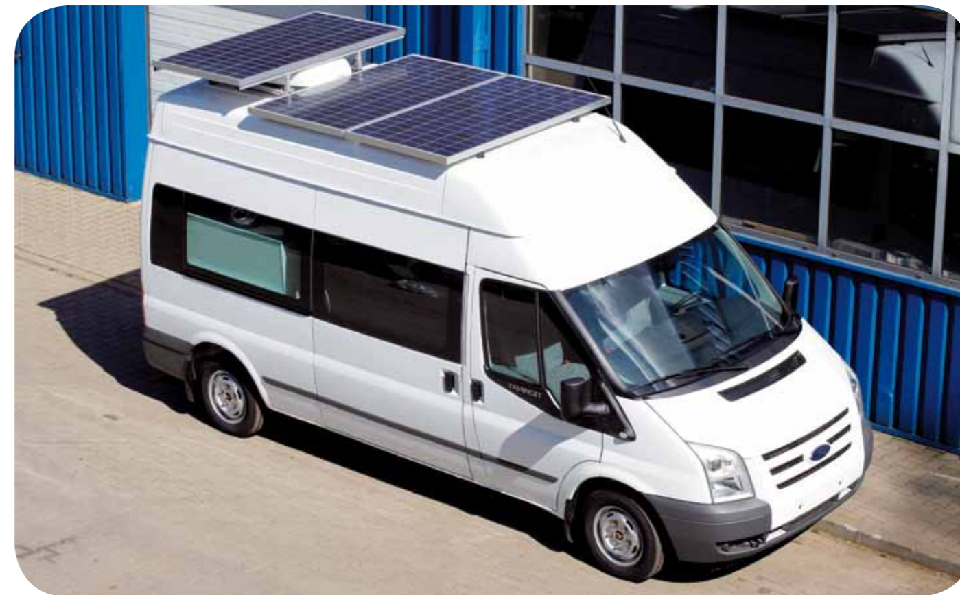
Klimatyzowane mobilne biuro zasilane ogniwami fotowoltaicznymi wykonane przez dra inż. Sebastiana Koziołka w ramach stażu w firmie D.S. Germaz Sp. z o.o. Materiały reklamowe firmy D. S. Germaz Sp. z o.o.
